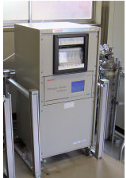
図2 乾式NO x 自動測定機の外観 (本体の下部に希釈装置が組み込まれている。右側にはNO標準ガスのシリンダーが置かれている。)
