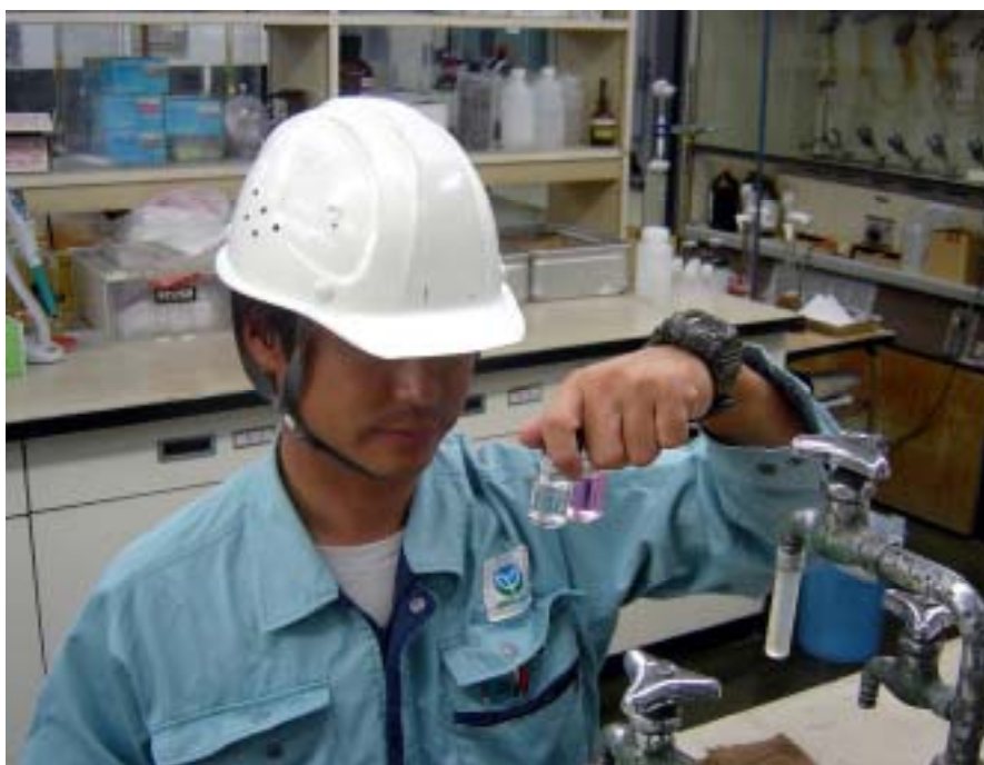
残留塩素計の試料をポータブル計で手分析しているところ。
