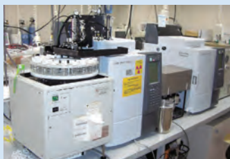
温室効果ガス3成分同時自動分析機 (独立行政法人 農業環境技術研究所)
