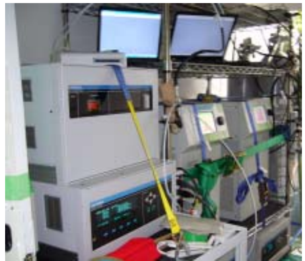
車載した測定器 (NH 3 計、EEPS など)
