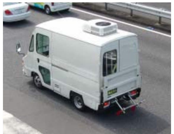
試験車が排出するナノ粒子を車載した測定器で計測をしている
